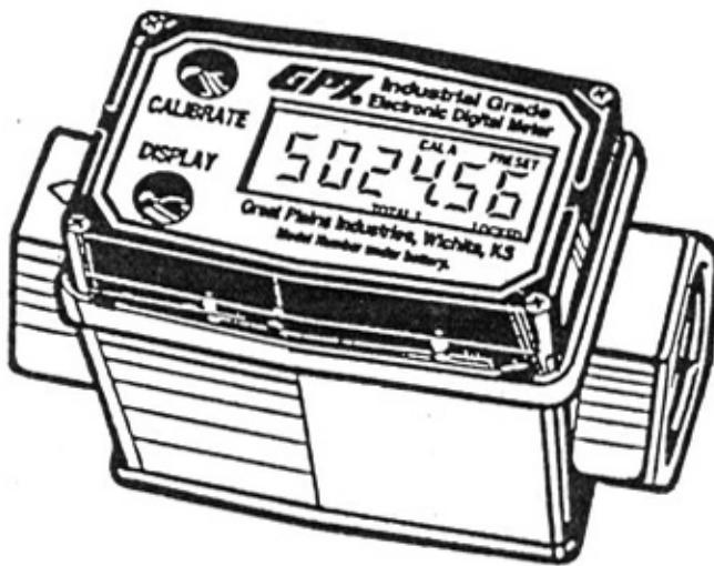
工業級MODEL S100渦輪式流量計的外殼為1英吋，可測量水流範圍2.5~50GPM (9.5~190 LPM)。標榜大範圍工業級與商業級測量應用。這些渦輪式流量計提供高精準度、精巧的設計與線外型的方式增加多樣性來配合各式的特殊需求。
